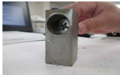
④打設終了後、ナットを緩めれば蒸気栓を抜く事が出来ます。
