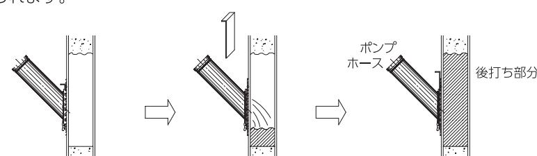
1. シャッター式Co打込治具をセットする。
