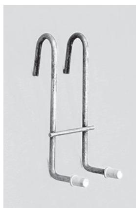
柱のフープ筋や壁筋へ掛けて側面のかぶりを確保する鋼製スペーサーです。
