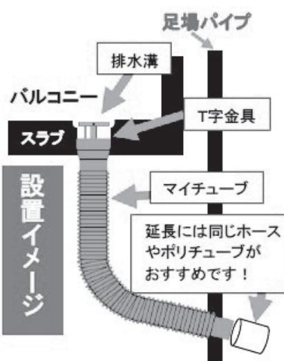
雨水排水補助用品  $\phi 75$ 専用
